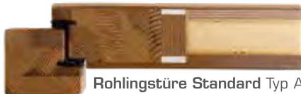
Rohlingstüre Standard mit Seitenteil Typ Allwetter Rahmenbreite 81 mm Rahmenstärke 84 mm Flügelstärke 68 mm
