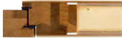
Rohlingstüre Typ Thermosafe 100 Rahmenbreite 81 mm Rahmenstärke 74 mm Flügelstärke 100 mm
